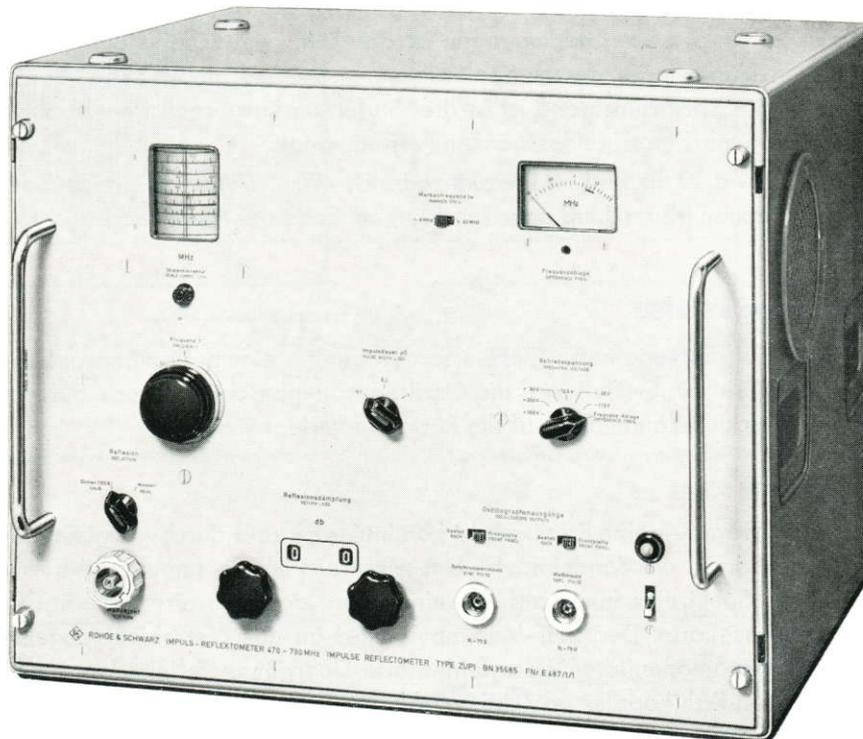
Das Impuls-Reflektometer ZUPI erfaßt die Fernsehbereiche IV und V. Es dient zur Reflexionsmessung und Fehlerortung, zu Antennenanpassungsmessungen und eignet sich auch zur Messung der Leitungsdämpfung. Charakteristische Merkmale sind
